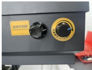
Control de calefacción y ventilador
